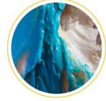
یشت اسلبها با توری و ایوکسی مستحکم شده و روی سنگ با غشایی از ایوکسی پوشیده و سپس سائیده می شود تا ریزترین ترکها و منافذ سنگ که با چشم غیر مسلح نیز قابل مشاهده نیست پر شده و استحکام، دوام و صیقل پذیری سنگ دوچندان گردد.
